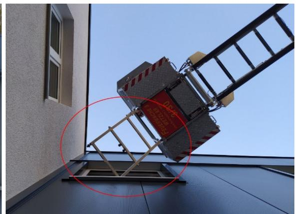
maximale seitliche Ausladung gem. Musterrichtlinien über Flächen für die Feuerwehr und die Überstiegssituation am Fenster
